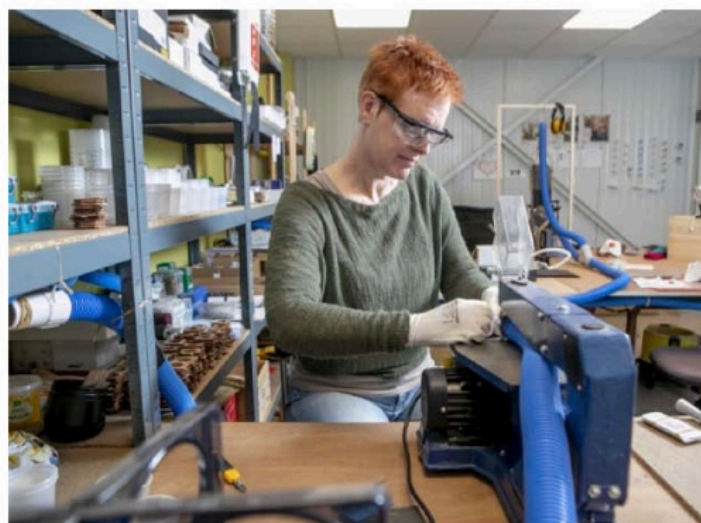
De blauwe plastic buizen die over de werktafels verspreid liggen zijn onderdeel van het afzuigsysteem dat Pascale zelf bedacht.
